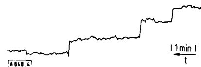
Abb. 4. Registrierstreifen eines „probe-hole“-Experimentes. Objekt: (110)-Gebiet von Wolfram, Gas: Stickstoff ( 10^{-8} Torr), Temperatur: 300 °K, Spannung: 340 V, Stromstärke: 10^{-13} + 10^{-12} A.
